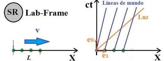
La densidad de momento se relaciona con la densidad de energía:  $\pi = \frac{Nm\gamma v}{L} = \frac{Nm\gamma c^2}{L} \cdot \frac{v}{c^2} \rightarrow \pi = \frac{\varepsilon}{c^2} \cdot v$
